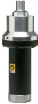
Pneumatik Zylinder der in der Endlage auf eine Kniehebelmechanik wirkt und dadurch eine Kraftverstärkung von 1:8 bis 1:10 erzeugt. Presskräfte bis zu 8 to (80 kN).
