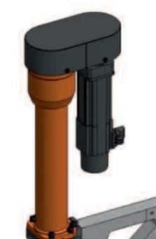
Antriebseinheit bestehend aus Servoelektromotor, der mittels Zahnriemengetriebe und Gewindetrieb eine präzise geführte Kolbenstange antreibt. Frei programmierbare Kraft/Verfahrcharakteristik z. B. für anspruchsvolle Fügeprozesse. Kraftbereich bis ca. 200 kN.
